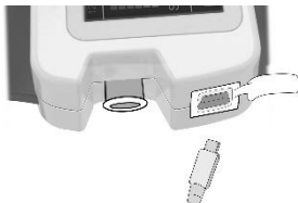
Εικόνα 5.16 Σχέδιο για τη σύνδεση μεταξύ του μετρητή οθόνης άπνοιας ύπνου και της γραμμής δεδομένων USB
