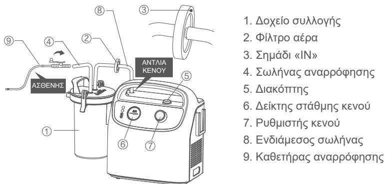
Εικόνα 2: Διάγραμμα σύνδεσης σωλήνα
